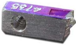
El diamante corta celdas moviéndose dentro y fuera del cobre de acuerdo a los datos de las señales recibidas por la cabeza grabado. El diamante viene en varios ángulos de punta para permitir diferentes profundidades de celda dependiendo de la aplicación de impresión.
