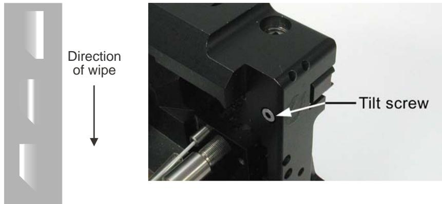
4. Gira el tornillo de inclinación para alcanzar una limpieza normal.
