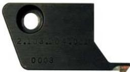
El cortador de rebaba elimina los bordes elevados (rebabas) en el exterior de las celdas. Tales rebabas son un efecto secundario esperado de un grabado normal y están directamente relacionados con la calidad del cobre y el ángulo de la pantalla que se corta. El cortador se monta directamente arriba del Estiletes para que pueda cortar las rebabas de las celdas recientemente grabadas.
