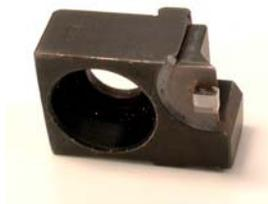
El zapato es un diamante de referencia. Mantiene la cabeza descansando sobre el cilindro durante el grabado. La zapata sigue la superficie del cilindro, ajustando la posición de la cabeza, mientras se graba para compensar imperfecciones de los cilindros.
